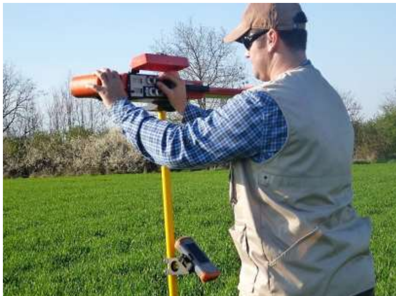
10. ábra EM38MK2 típus talajszkenner kalibrációjának végzése
