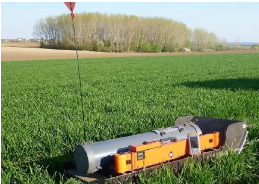
9. ábra EM38MK2 típus talajszkenner
