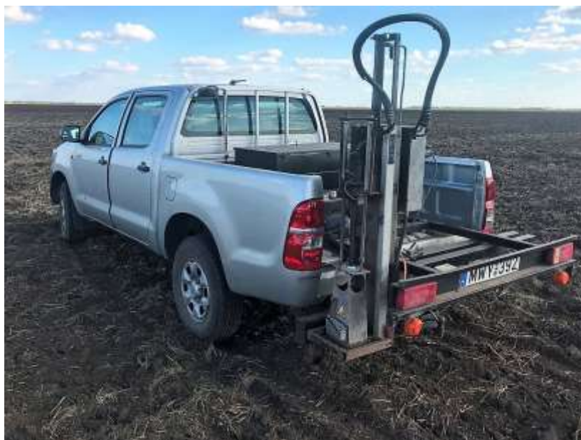
15. ábra Talaj-mintavételezést végző eszköz
