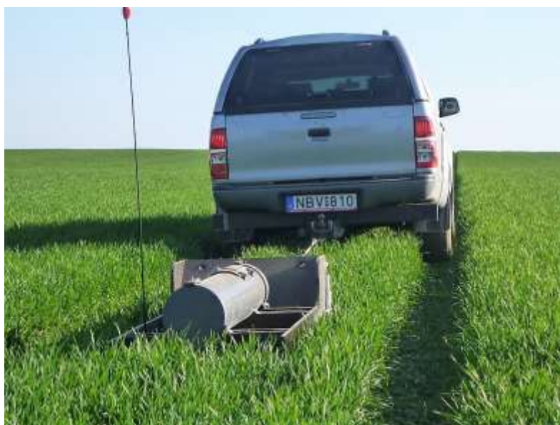
11. ábra EM38MK2 típus talajszkenner
